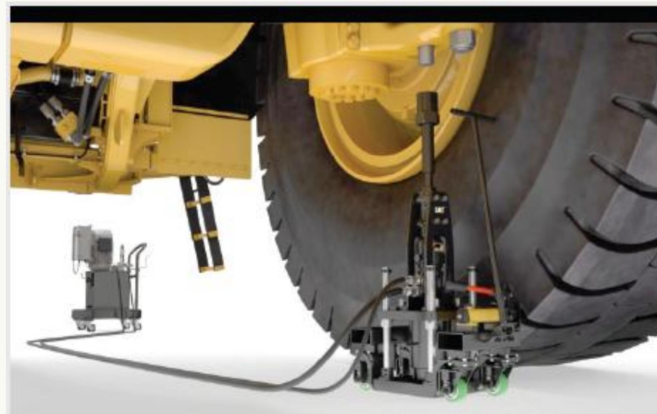
El rompedor de pernos esféricos viene equipado con una plataforma rompedora personalizada, 2 herramientas de trabajo, 4 extensiones, 3 adaptadores y un protector de seguridad configurable para todos los modelos de listados.
