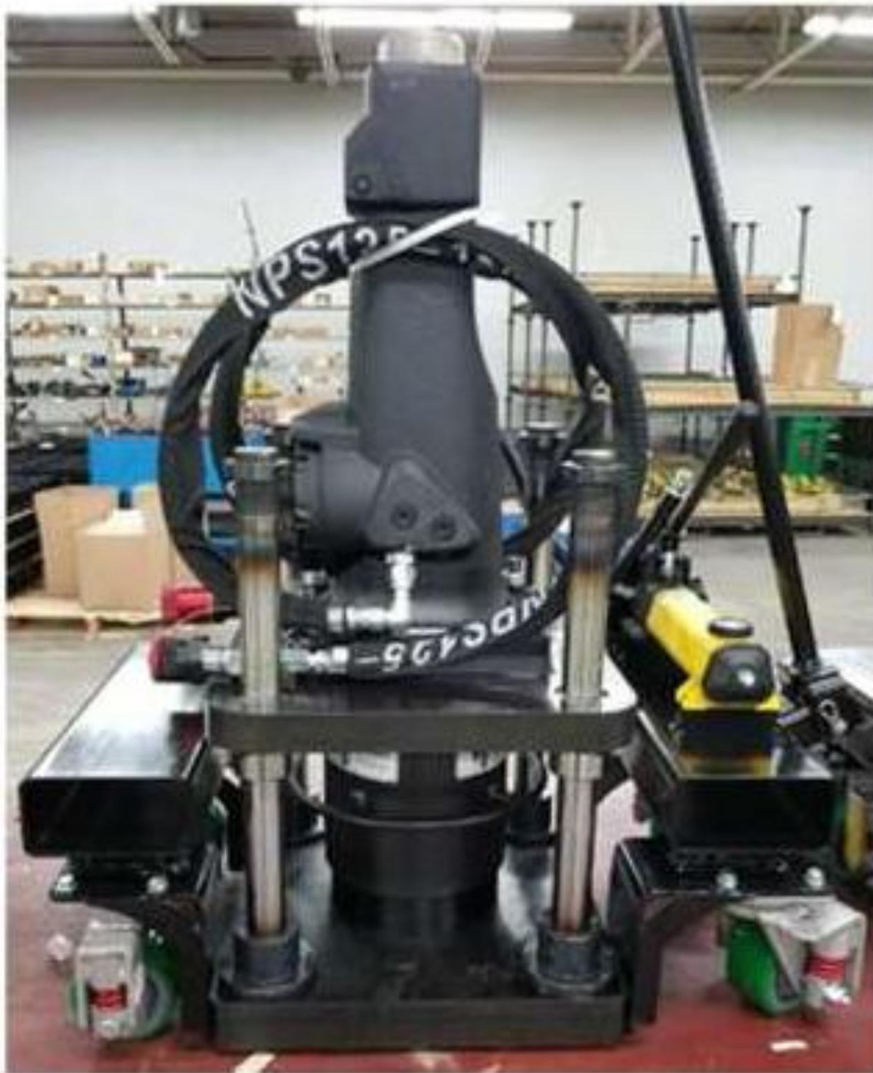
El grupo de martillos separa la interfaz cónica entre los cilindros de pasador/perno esférico y los componentes de la dirección ubicados en los camiones mineros grandes Cat 789, 793, 795 y 797.
